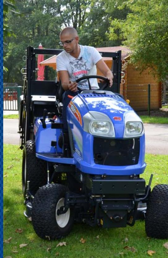
La tondeuse Iseki SXG 216 est équipée d'un tableau de coupe de 102 cm avec éjection arrière. La SXG323 est dotée d'un tableau de coupe de 122 cm, la SXG326 est disponible avec des largeurs de coupe de 122 cm ou de 137 cm et est disponible en version mulching d'une largeur de 137 cm.
